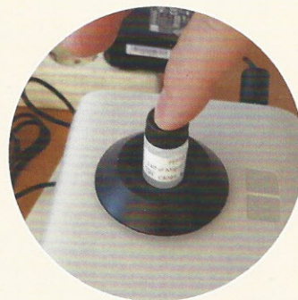
Vermischen für ca. 10 Sekunden mit dem Vortex- Mischer
