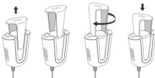
Nachjustieren des Unterdrucks durch die Pumpeinheit
