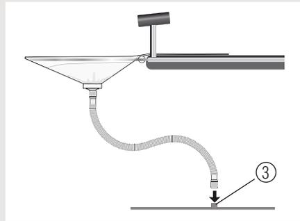
Anschließend wird der Schlauch mit einem geeigneten Ablauf (9) verbunden.
