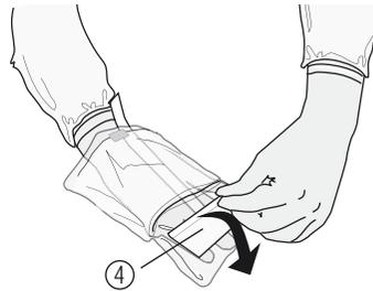
Mit der freien Hand wird das Schutzpapier (4) der Haftfläche nach vorne abgezogen. Hierzu dient die von der Haftfläche abgelöste Lasche des Schutzpapiers.
