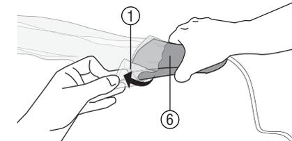
Nach der Anwendung die Haftfläche (1) vom Ultraschall-Kopf (6) langsam abziehen. Es bleiben keine Kleberückstände zurück.
