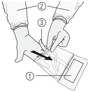
Den Bezug mit der Haftfläche (1) nach oben platzieren - die sterile Person (2) greift unterhalb des Klebestreifens (3) ins Innere des Bezuges.
