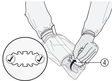
Mit der freien Hand wird das Schutzpapier (4) zunächst an einer der beiden kurzen Seiten (✓) von der Haftfläche abgelöst und anschließend im Ganzen abgezogen.
