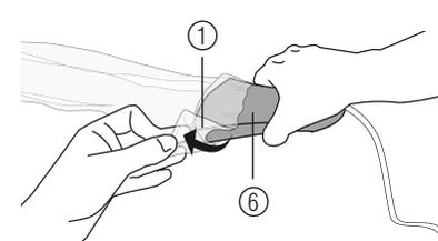
Nach der Anwendung die Haftfläche (1) vom Ultraschall-Kopf (6) langsam abziehen. Es bleiben keine Kleberückstände zurück.
