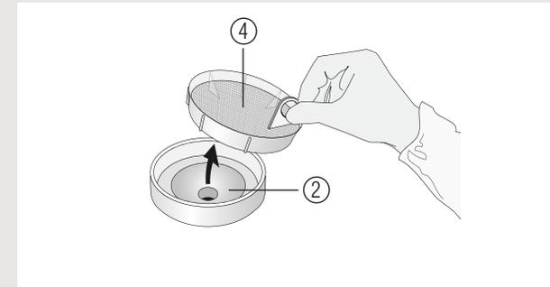
Das Filtersieb (4) hält Gewebeteile zurück und verhindert so ein Zusetzen der Leitung. Es kann aus dem Ablaufstutzen (2) entnommen werden.
