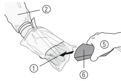
Der Springer (5) platziert den Ultraschallkopf (6) auf die Haftfläche (1) - die sterile Person (2) streicht vom Inneren des Bezuges die Haftfläche fest. Bei korrekter Installation haftet das Produkt faltenfrei am Ultraschallkopf. Bei eventueller Faltenbildung ist eine Neupositionierung des Bezugs auf dem Ultraschallkopf möglich.
