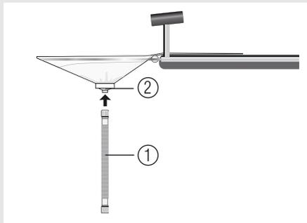
Der Faltenschlauch (1) wird an den Ablaufstutzen (2) des Auffangbeutels gesteckt.
