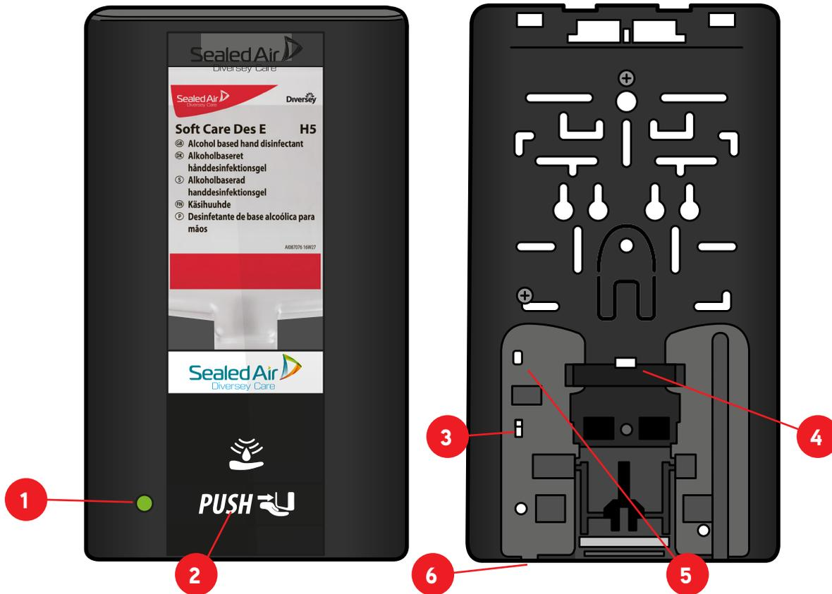
1. Betriebsanzeige 2. erscheint bei schwacher Batterie 3. Einstellung der Dosiermenge 4. Dosiermengenzähler 5. Sperre bei offener Abdeckung 6. Sensor
