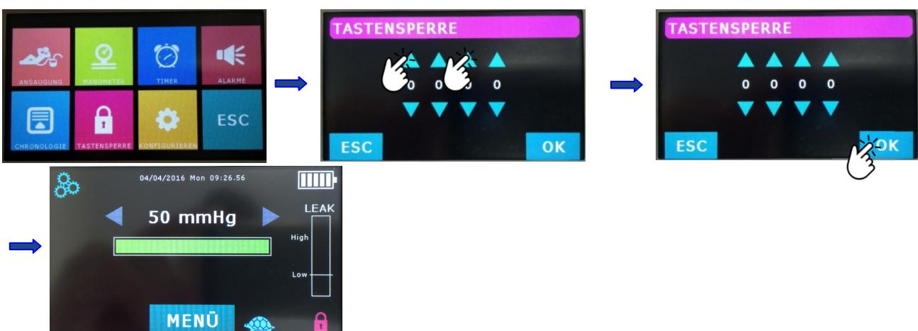
Die Tastensperre bleibt auch bei Ab- und Wiederanschalten des Geräts bestehen.
