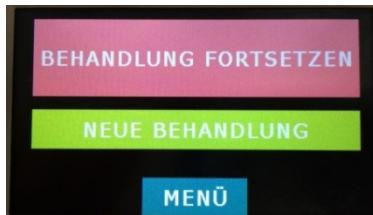
Auf die Schaltfläche **MENÜ** drücken, um das Hauptmenü aufzurufen, dort auf **KONFIGURIEREN**, um das **KONFIGURATIONSMENÜ** aufzurufen, wo dann **ALARMTEST** betätigt wird.
